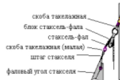
рис.10. Узел крепления вант.
