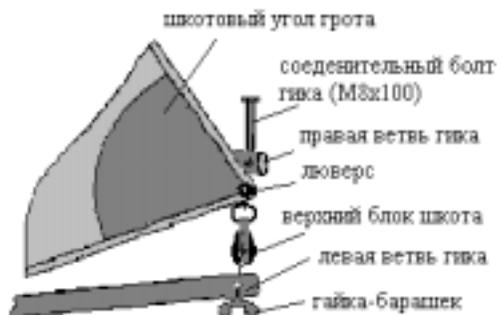
рис.13. Крепление шкотового угла грота к гике.
