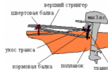
Рис.14. Транцевая доска.
